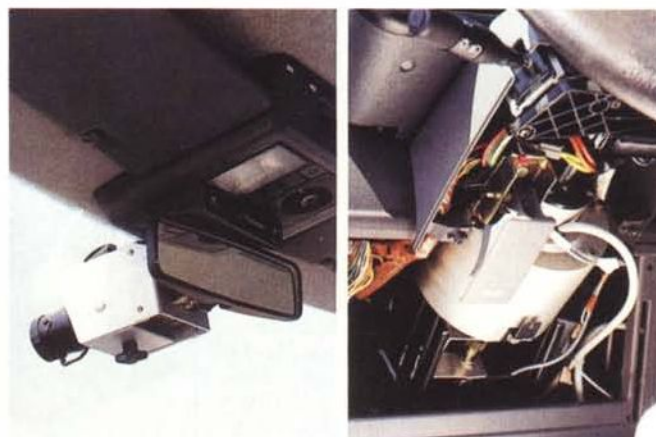
Fig. 14: La telecamera ed il sistema di attuazione sul volante nel sistema per il mantenimento automatico della corsia di marcia studiato da Renault.
